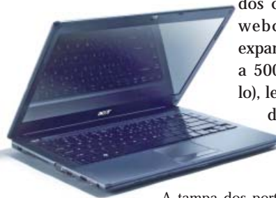
A tampa dos portáteis foi desenvolvida em alumínio, garantindo leveza ao produto
